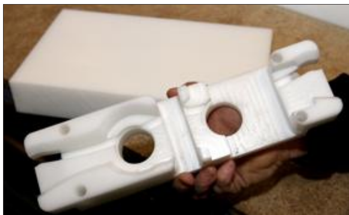
Les pièces complexes et sur mesure, comme celle-ci, sont taillées, rabotées, percées... à partir d'un bloc de plastique tel que celui visible en arrière-plan.
