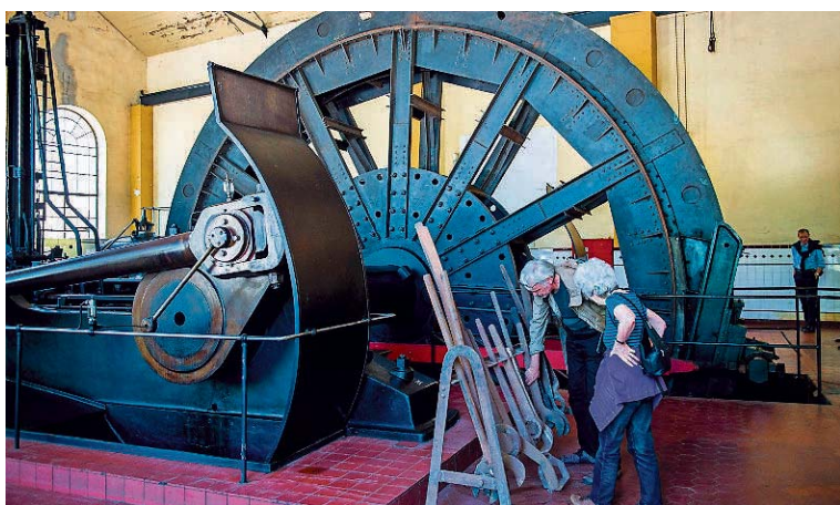
Die mächtige, einstmals dampfgetriebene Fördermaschine der Grube Velsen braucht regelmäßige Pflege.
